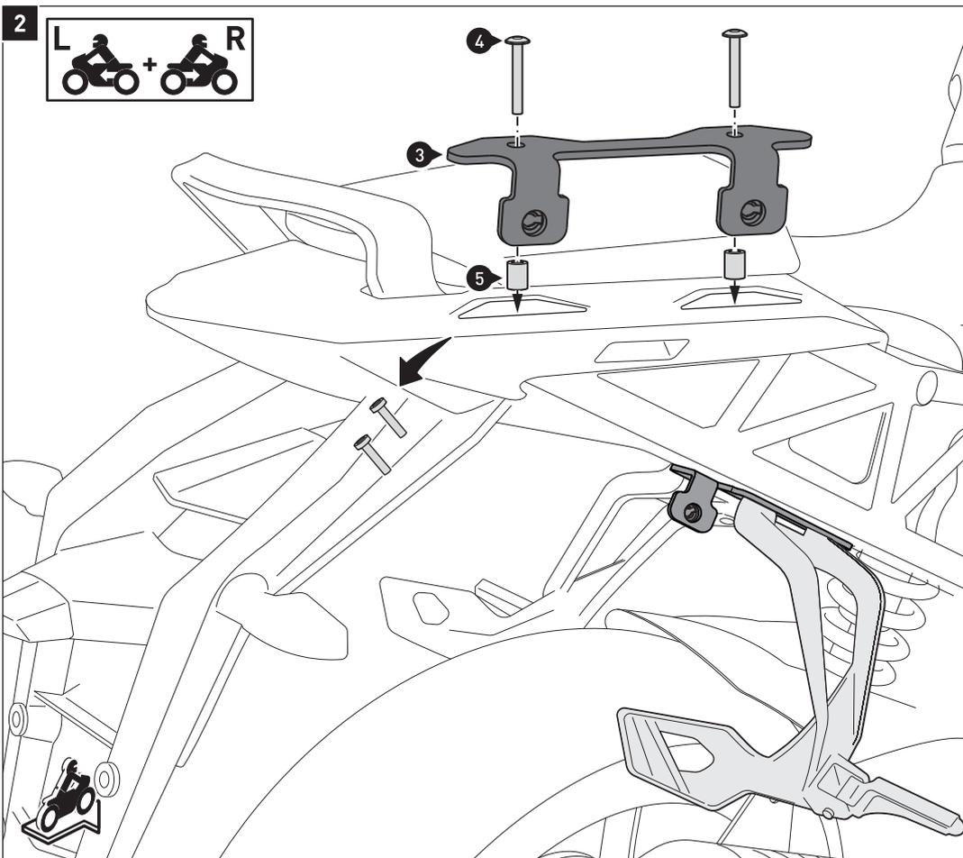
Entfernen Sie die originalen Schrauben aus den Heckmulden des Fahrzeugs.
