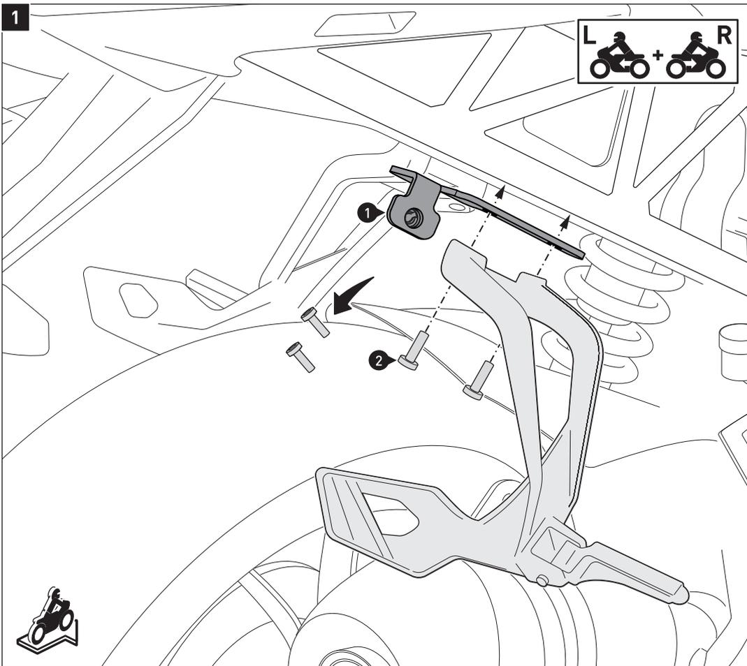
Entfernen Sie die originalen Schrauben von den Soziusfußrastenhaltern.
