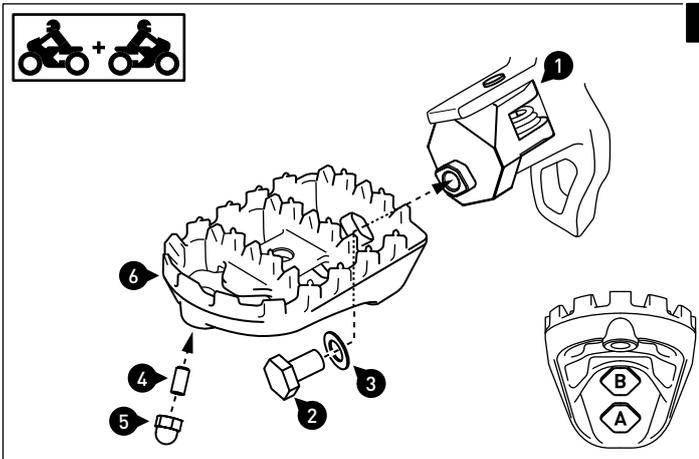
**3** Verschrauben Sie beidseitig die Fußrasten (6) an den Gelenkadaptern (1).
