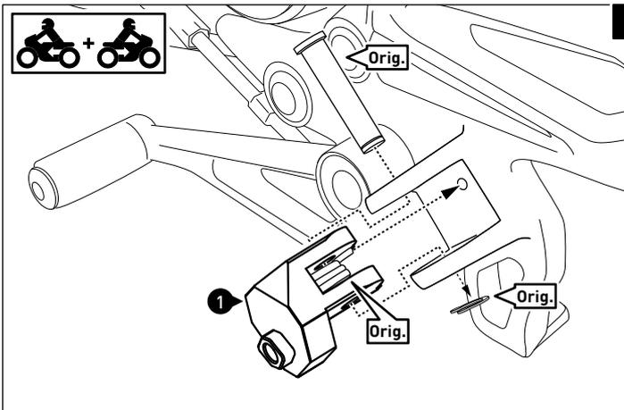
**2** Verbauen Sie nun die Gelenkadapter (1) mit den originalen Teilen beidseitig am Fahrzeug. Achten Sie darauf, dass das Federendstück in der Fußrastenaufnahme stecken muss.
