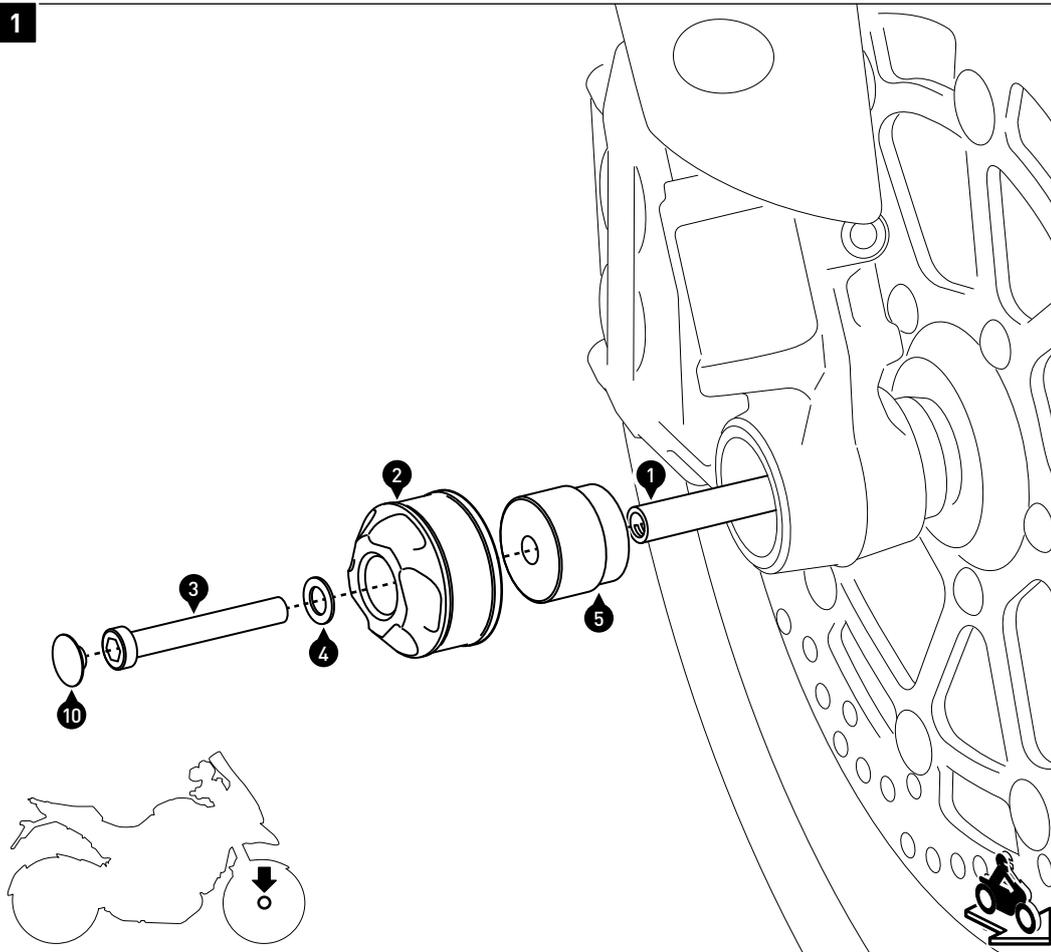
Montieren Sie das Achssturzpad auf der rechten Fahrzeugseite, wie in der Zeichnung gezeigt.
