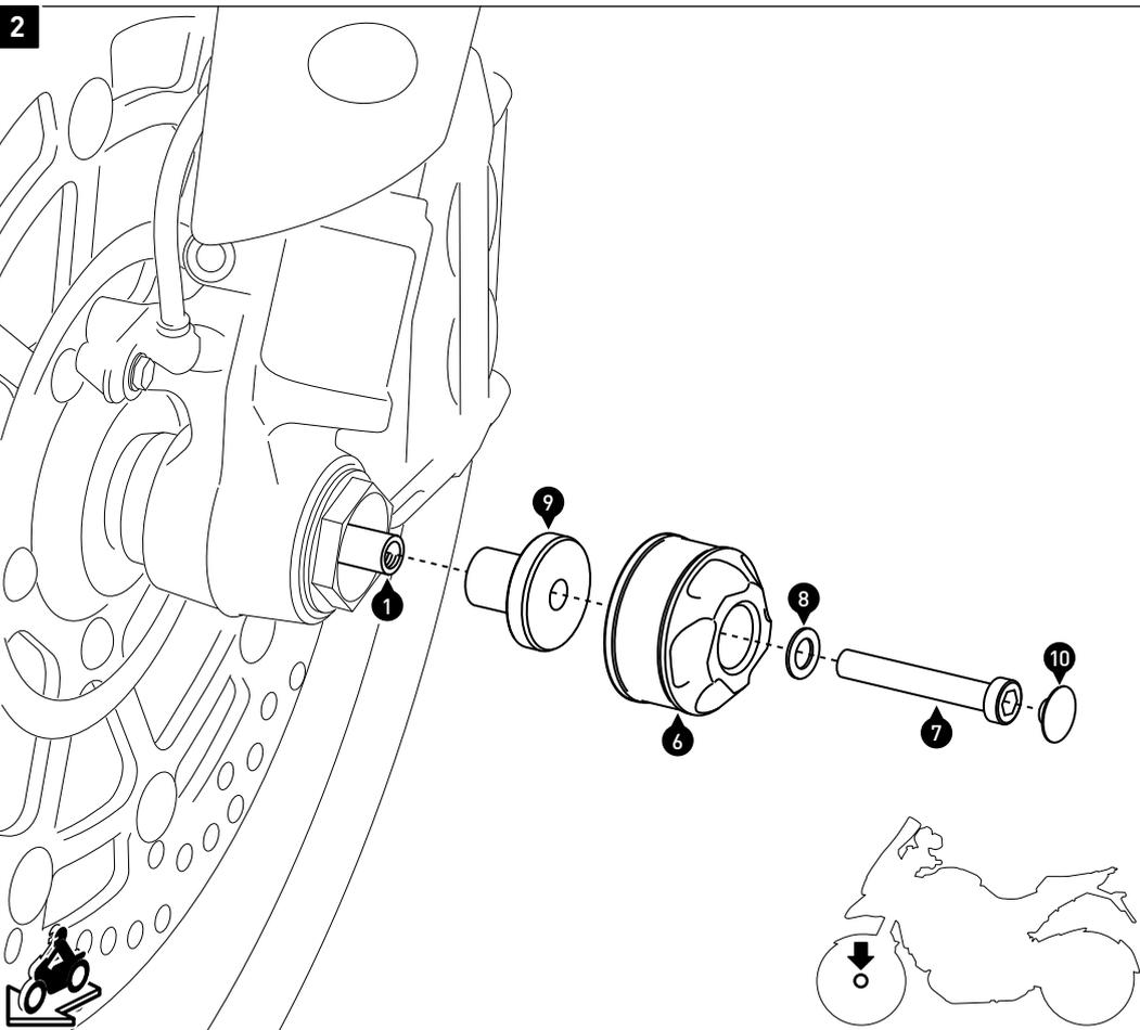
Montieren Sie anschließend das Achssturzpad auf der linken Fahrzeugseite, wie in der Zeichnung gezeigt.
