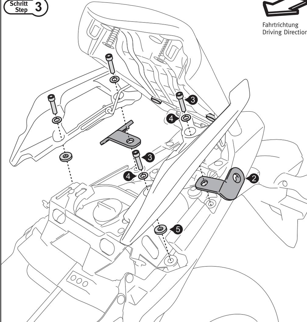
Verschrauben Sie die Befestigungsbleche (2) mit den Sozias-Haltegriffen am Fahrzeug. **Sichern Sie die Schrauben (3) mit flüssiger Schraubensicherung.** Ziehen Sie die Schrauben (3) noch nicht an.
