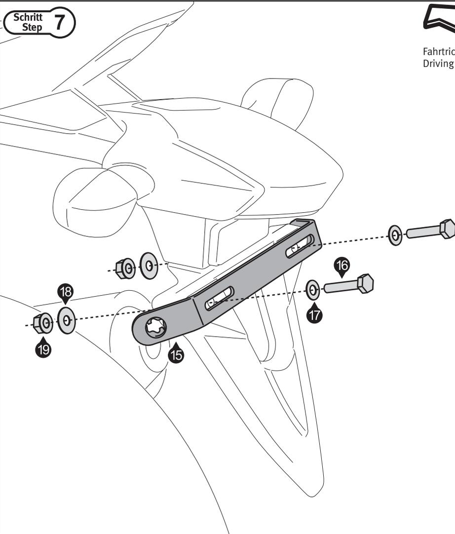
Verschrauben Sie den Querverbinder (15) am Kennzeichenhalter wie gezeigt. Ziehen Sie die Schrauben (16) noch nicht an.
