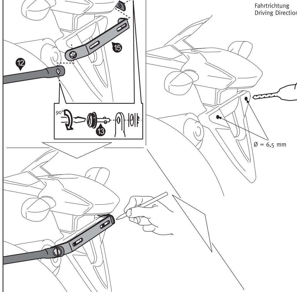
Verbinden Sie beide Kofferträger (12) an den hinteren Befestigungsauslegern mit dem Querverbinder (15). Benutzen Sie auch hier die Schnellverschlüsse (13).
