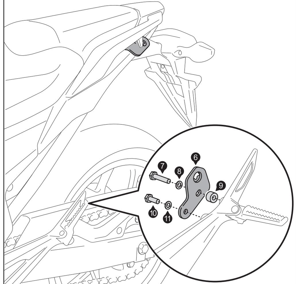
Montieren Sie die Befestigungsbleche (6) beidseitig hinter den Sozias-Fußrasten, wie gezeigt. **Sichern Sie die Schrauben (7) und (10) mit flüssiger Schraubensicherung.** Ziehen Sie die Schrauben (7) und (10) noch nicht an.
