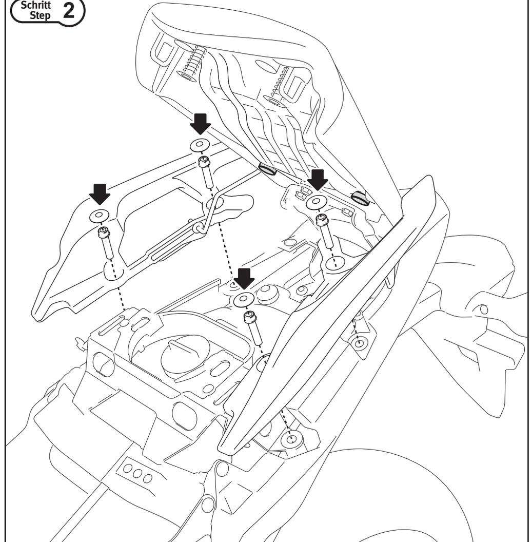
Entfernen Sie die Kunststoffabdeckungen und die originalen Schrauben der Sozius-Haltegriffe. Entfernen Sie anschließend vorsichtig die Sozius-Haltegriffe vom Fahrzeug.
