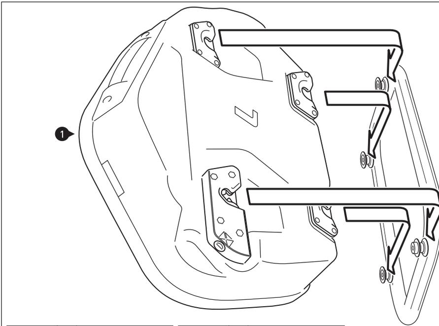
Den AERO ABS-Seitenkoffer einfach seitenweise am QUICK-LOCK EVO-Kofferträger Adapterkit AERO (separat erhältlich) einhängen, nach unten drücken und abschließen.
